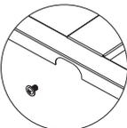
7º Com a prateleira (PRA) enclinada encaixe-a nas colunas e nas laterais (LA); após encaixada parafuse-a nas costas (FU).
