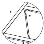
Encaixe a parte da frente da divisória por dentro da coluna e gire a parte de trás até encostar na prateleira depois fixe com parafusos M4x6mm e porcas M4.
